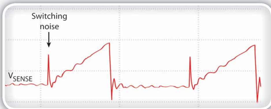
Slika 4: Preklopne motnje na V_{sense}
