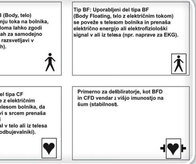
Slika 1: Klasifikacija uporabljenih delov (vir slike: TDK-Lambda)
