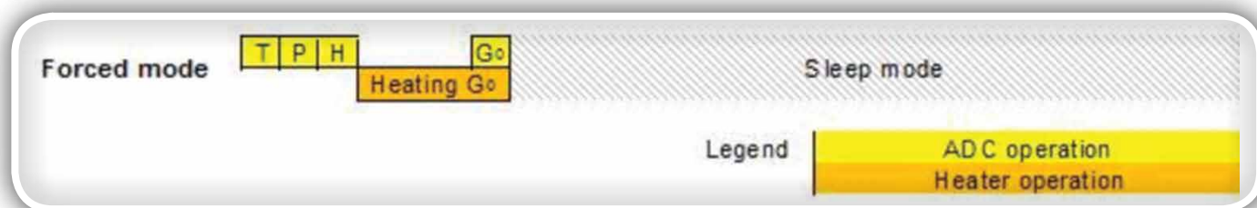
Slika 5: Naprava Bosch Sensortec BME680 v stanju vsiljenega načina delovanja najprej zaporedoma vzorči senzorje temperature, tlaka in vlažnosti in nato izvede segrevanje senzorja za plin. (Vir slike: Bosch Sensortec)
