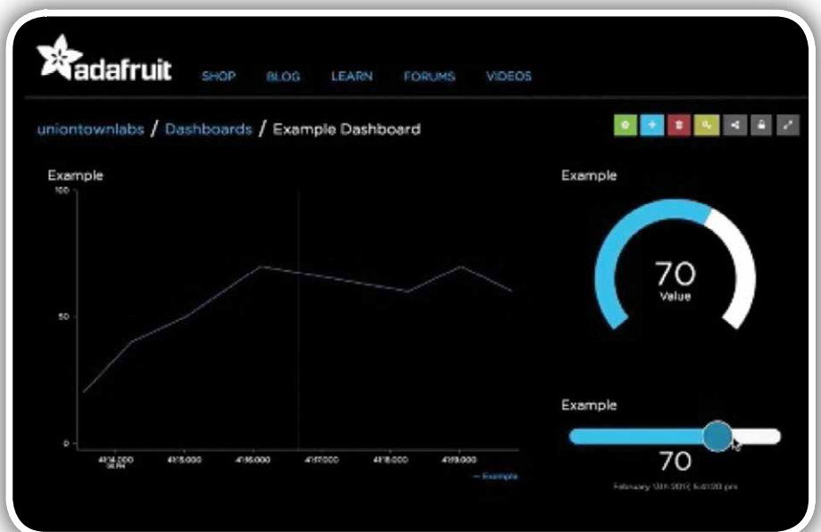
Slika 3: razvijalci lahko prikazujejo informacije iz svojih aplikacij za industrijsko avtomatizacijo, ki temeljijo na platformi Raspberry Pi 3, in zagotovijo nadzor z nadzorno ploščo Adafruit IO. (Vir slike: Adafruit)
