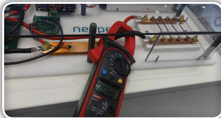
Slika 5: NextPower MOSFET tranzistor med demonstracijo delovanja
