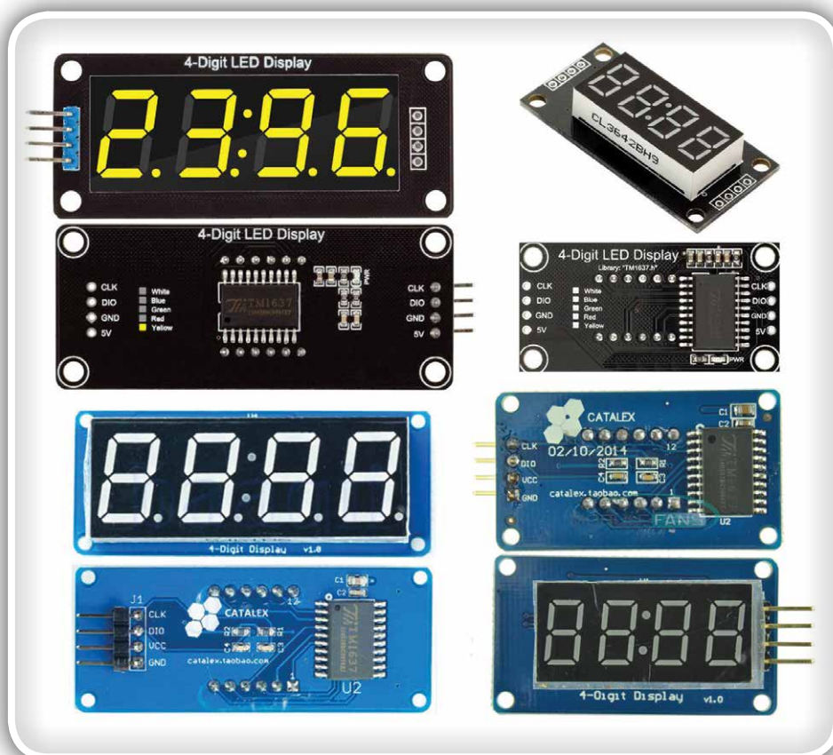
Slika 36: Moduli za prikaz časa s TM1637 čipom
