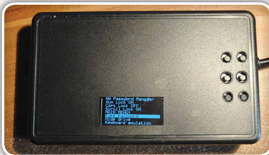
Slika 1: Strojni upravljalnik gesel z razširjeno tipkovnico
