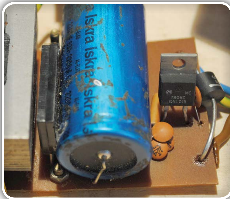
Slika 6: Klasični 5V stabilizirani napajalnik s transformatorjem, diodnim usmernikom, regulatorjem in zaščitno diodo
