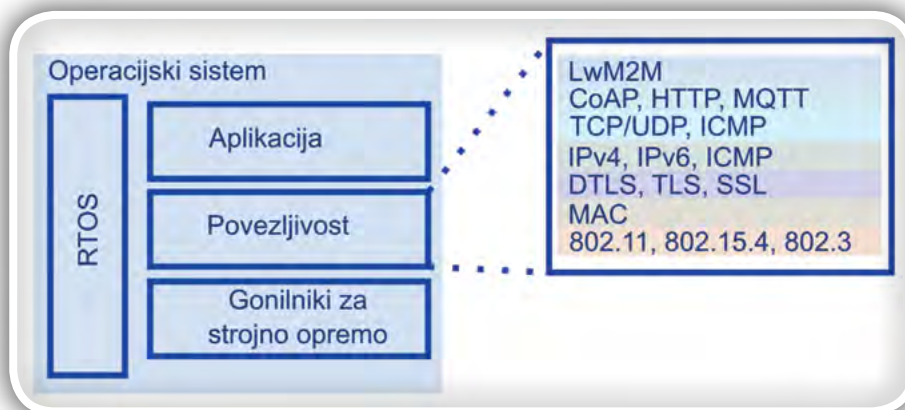
Slika 4: Podrobna zgradba povezljivostnega sloja operacijskega sistema
