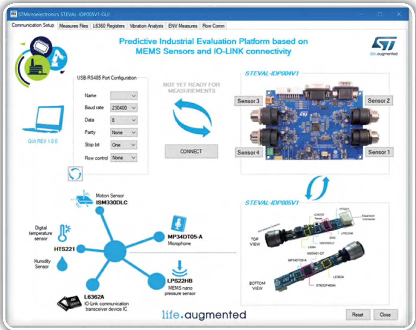
Slika 4: Z vmesnikom GUI ST Windows lahko razvijalci hitro konfigurirajo senzorske plošče, izvajajo zbiranje podatkov ter si ogledujejo rezultate podatkov o gibanju iz frekvenčne in časovne domene, pa tudi okoljske podatke. (Vir slike: STMicroelectronics)
