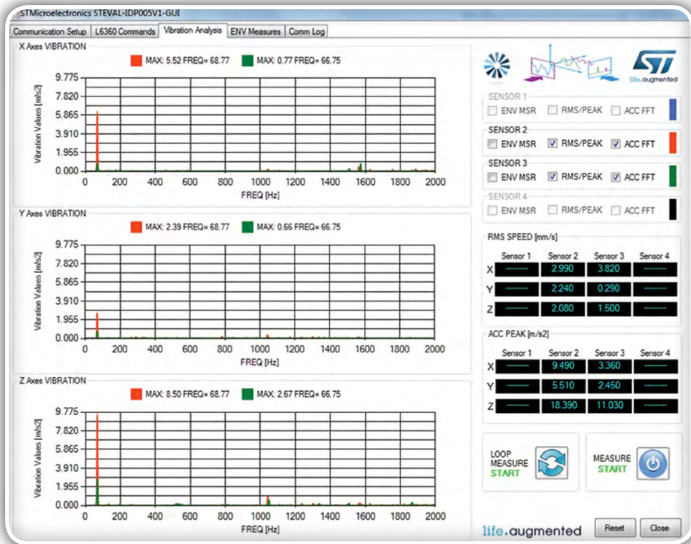
Slika 5: GUI ST Windows ponuja preprost pristop za ocenjevanje senzorskih podatkov z možnostjo predstavitve rezultatov frekvenčne in časovne domene iz senzorja gibanja. (Vir slike: STMicroelectronics)
