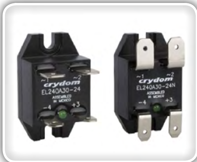
Slika 9: Serija EL240A SSR-jev podjetja Crydom/Sensata Technologies podpira tokokroge z do 30 A in z vhodnim kontrolnim signalom z do 24 voltov enosmernega toka. (Vir slike: Crydom/Sensata Technologies)
