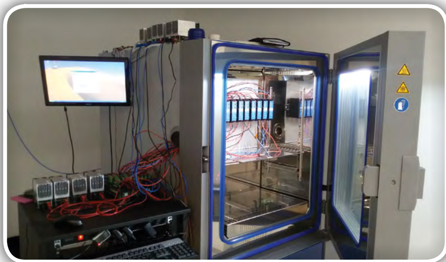
Slika 2: Tipična postavitve preizkusa med delovanjem, na primer 96-urnega preizkusa ali preizkusa zmanjšanja moči. Vir slike (Recom)
