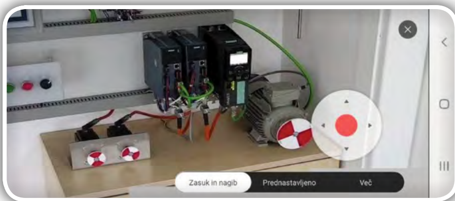
Slika 2: Pogled na frekvenčne regulatorje preko mobilne aplikacije. 15-kratna optična povečava omogoča odčitavanje napak na zaslonu regulatorja.
