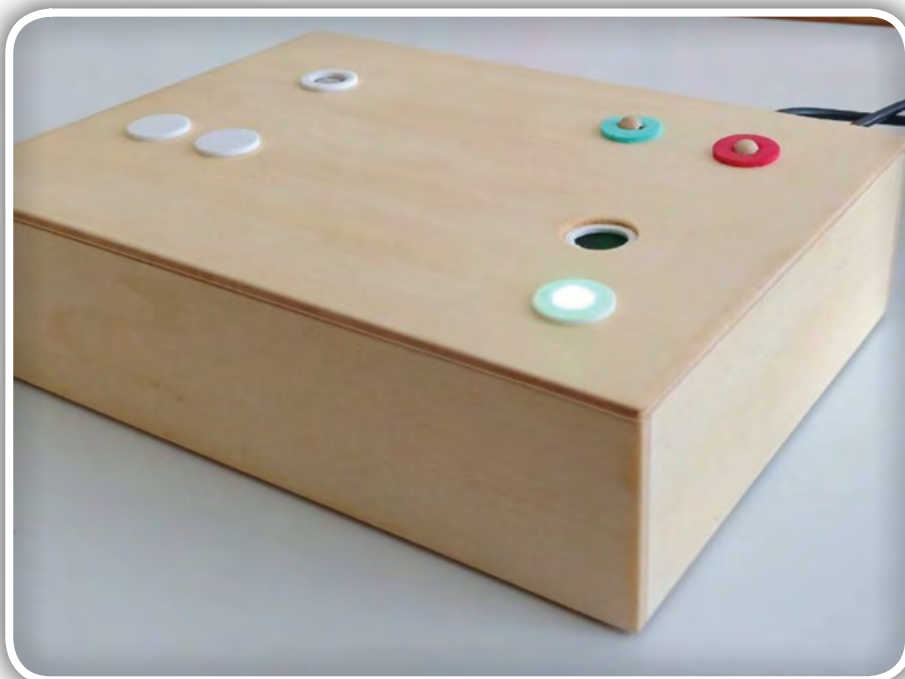
Slika 2: Alarmna naprava z vidnimi deli v smeri ure od zgoraj levo PIR s podlogo za mobilni telefon, gumb A (zeleni), gumb B (rdeči), zvočnik in RGB
