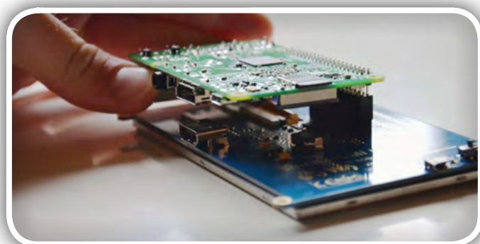
Slika 2: Nameščanje zaslona: oba HDMI priključka priključite na HDMI povezovalni konektor
