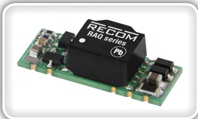
Slika 3: Pretvornik DC/DC RECOM RAQ-0505S za avtomobilsko industrijo
