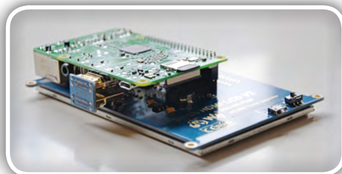
Slika 2: Nameščanje zaslona: oba HDMI priključka priključite na HDMI povezovalni konektor
