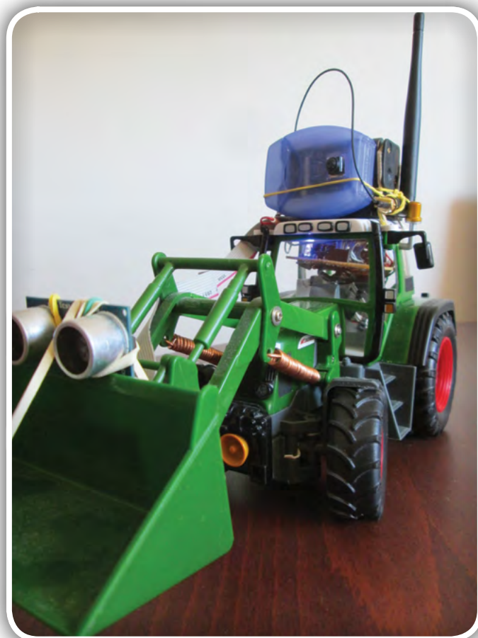
Slika 1: IoT model traktorja z dodano kamero in tipalom za oddaljenost
