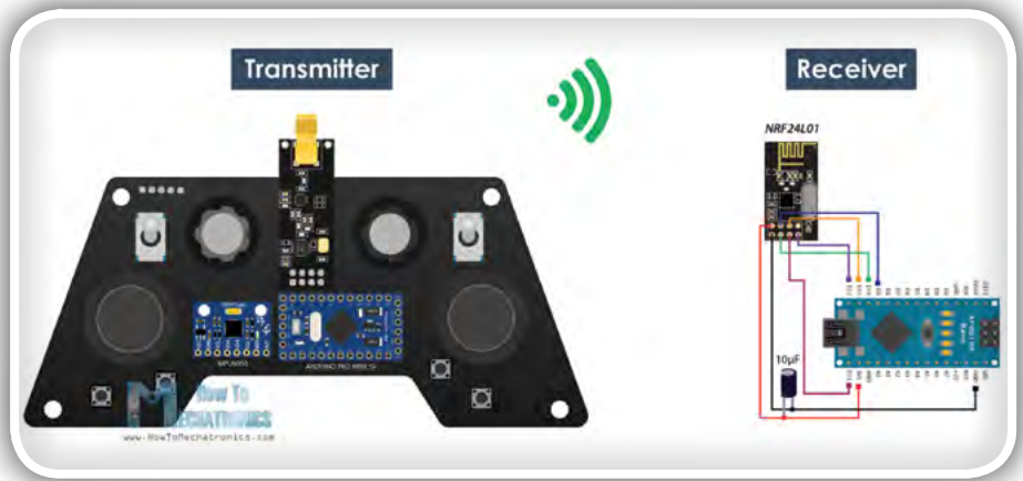
Slika 24: Blok shema povezave
