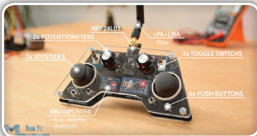
Slika 2: Kaj imamo na RC oddajniku
