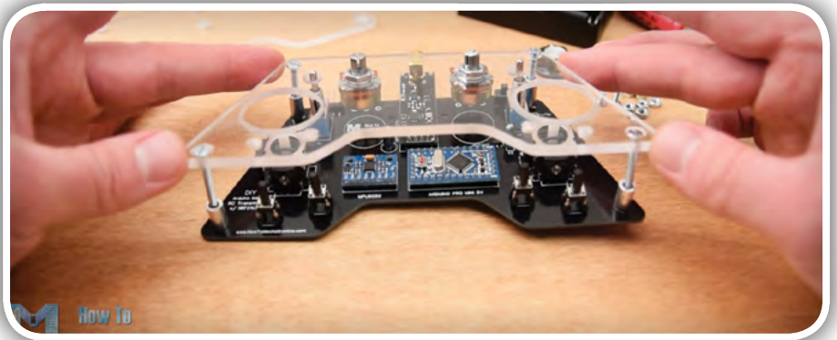
Slika 18: Distančniki in vijaki, nameščanje zgornje plošče
