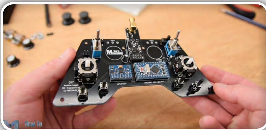
Slika 12: Dokončana ploščica, vendar brez potenciometrov
