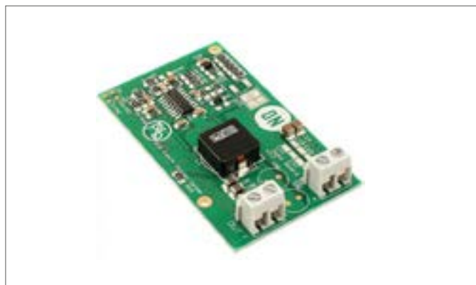
Slika 8: Razvojna plošča NCP1034BCK5VGEVB vključuje več možnosti, ki so razvijalcem v pomoč pri hitrem začetku razvijanja novih zasnov. (Vir slike: Digi-Key Electronics)
