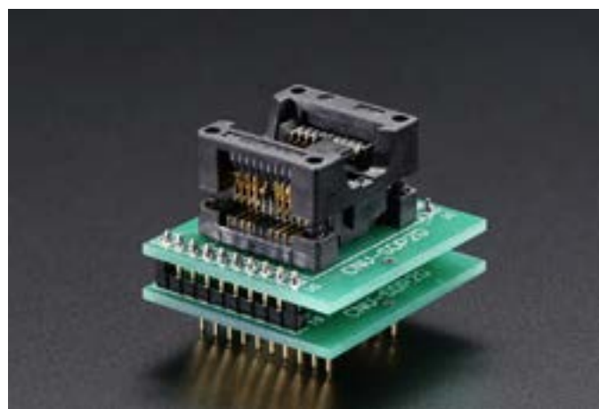
Slika 5: ZIF adapter (avtor: John Bradnam)
