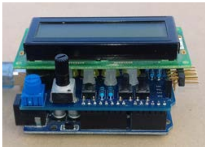
Slika 29: Ko se alfanumerični displej postavi na Shield-A, bo prekrival svetleče diode
