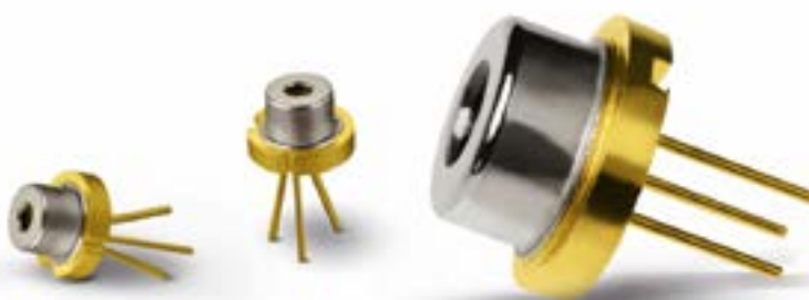
Slika 4: Impulzne laserske diode serije 905xxUA podjetja Laser Components izpolnjujejo zahteve AEC Q101 in imajo izhodno moč do 110 W pri valovni dolžini 905 nm. (Vir slike: Laser Components)
