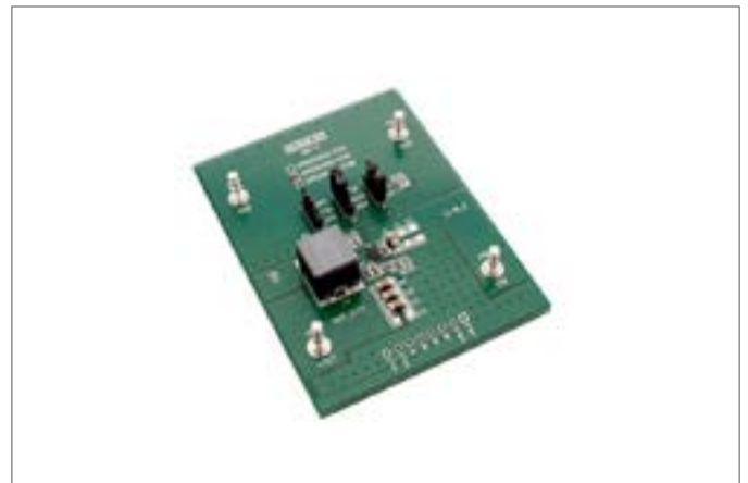
Slika 6: Razvojna plošča AP62600SJ-EVM zagotavlja preprosto in priročno okolje za ocenjevanje modela AP62600. (Vir slike: Digi-Key Electronics)
