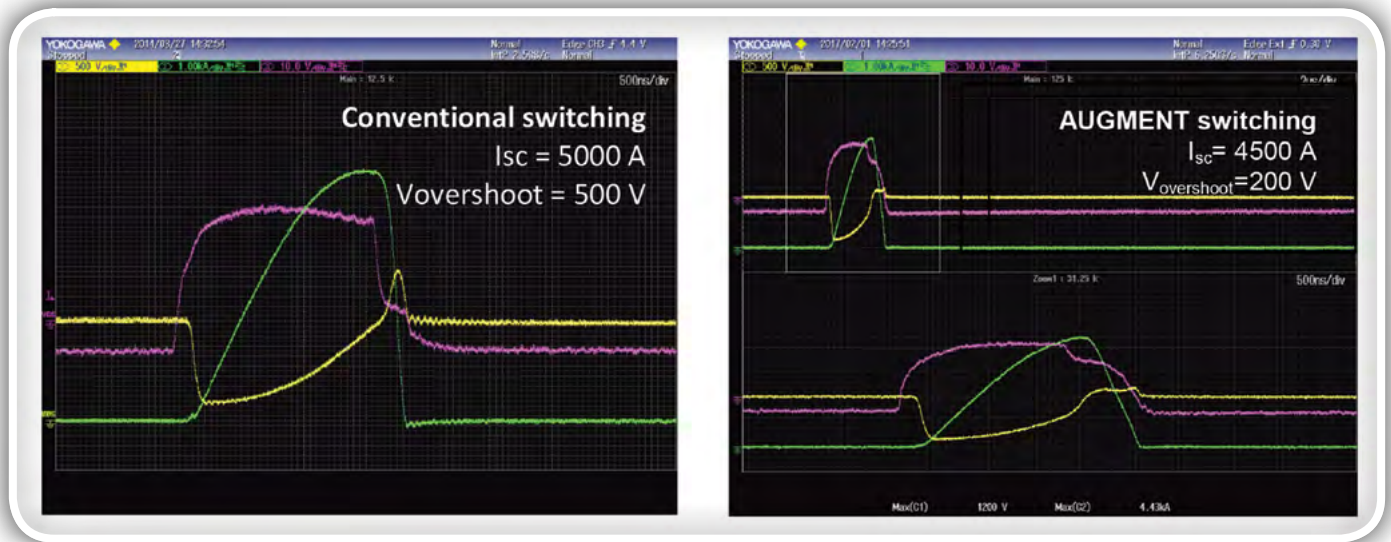
Slika 7: Prikaz, kako lahko razširjeno preklapljanje (desno) zmanjša vršno napetost in največji tok med kratkim stikom v primerjavi z običajnim preklpom (levo).
