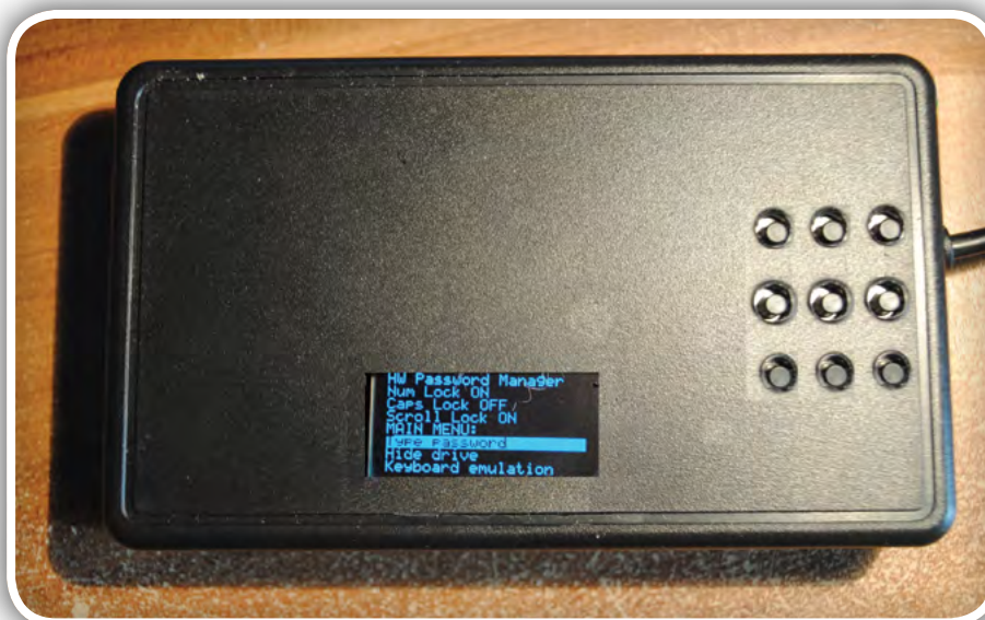
Slika 2: Doma narejen upravljalnik gesel s tipkovnico iz mikro tipk.
