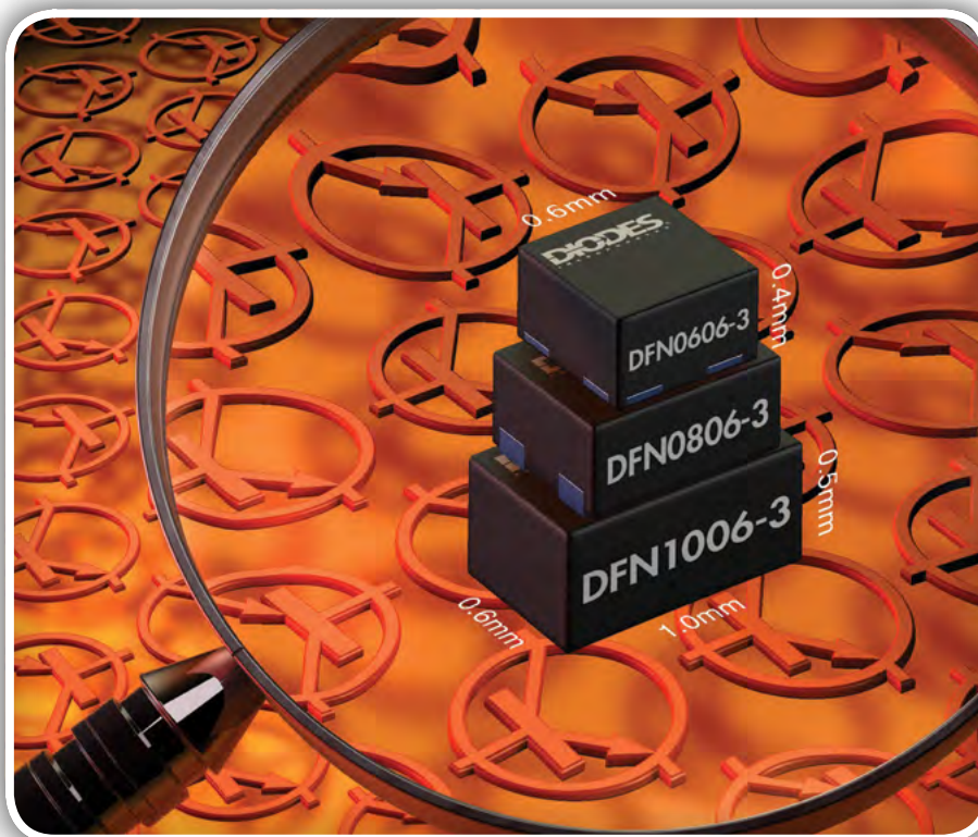
Slika 2: 45-voltni bipolarni NPN-tranzistor za majhne signale BC847BFZ iz podjetja Diodes je za 40 % manjši od primerljivih komponent v ohišjih DFN1006, SOT883 in SOT1123, vendar zagotavlja večjo zmogljivost. (vir slike: Diodes)
