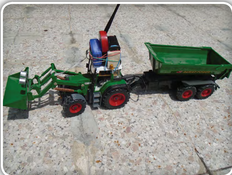
Slika 1: Robotski traktor, ki ga skupaj krmilita ESP32 in ESP8266, povezana prek RS232 povezave.
