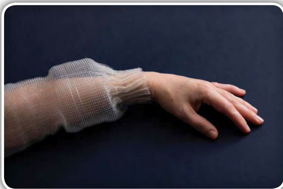
Slika 1: Raziskovalci na MIT so ustvarili prvo tkaninsko vlakno z digitalnimi zmožnostmi, ki je pripravljeno zbirati, shranjevati in analizirati podatke z uporabo nevronske mreže. Zasluge: Slika: Anna Gittelson. Foto: Roni Cnaani.
