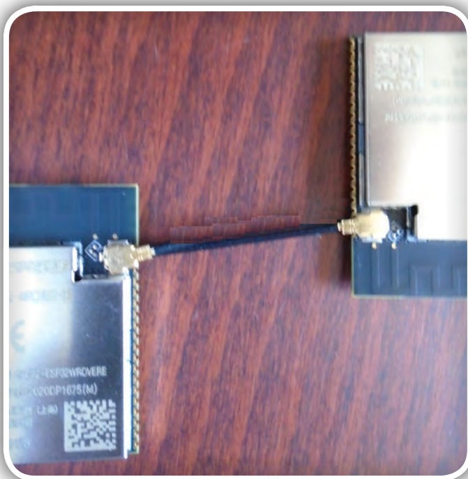
Slika 5: Kako povezati zunanjo anteno na Wi-Fi modul brez antenskega priključka.
