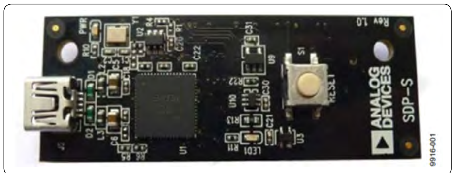
Slika 5: Za zagotavljanje USB povezave med ploščico EV-ADF4401ASD2Z in računalnikom za programiranje je potrebna ploščica s krmilniki EVAL-SDP-CS1Z (ali SDP-S). (Vir slike: Analog Devices)
