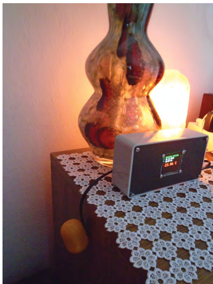
Slika 7: Vremenska postaja v3.0 z zunanjim merilnikom za temperaturo v oranžni škatlici
