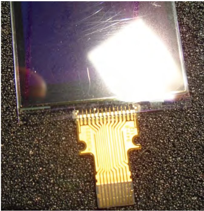
Slika 2: Črno-beli prikazovalnik SHARP LS013B7DH03 z zadnje strani
