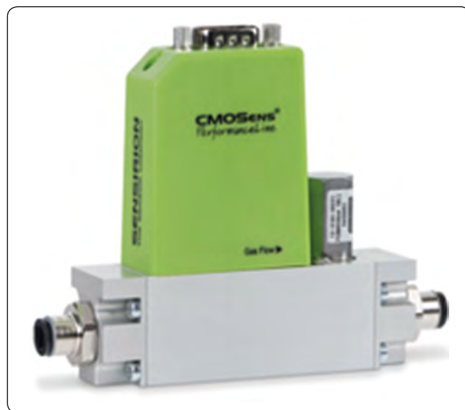
Slika 1: Družina regulatorjev masnega pretoka Sensirion SFC5500 uporablja mikrotermično tehnologijo CMOSens za natančno merjenje prostornine plina skozi kanal pretoka plina, ne glede na temperaturna ali tlačna nihanja. (Vir slike: Murata)
