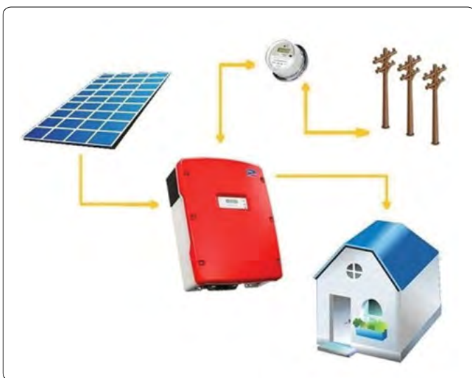
Shema ongrid fotovoltaičnega sistema. Vir: www.kenbrooksolar.com
