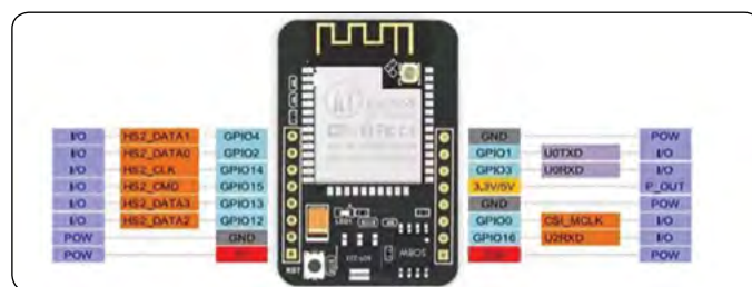
Slika 4: Razpored priključkov na ESP32
