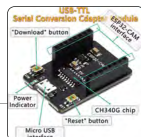
Slika 6: Adapter se poveže z ESP32 preko povezovalnih letvic.
