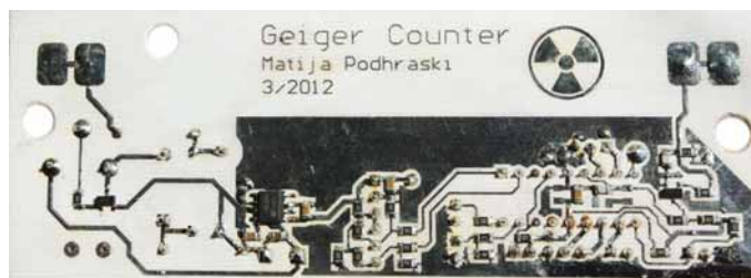
Slika 3: Spodnja stran pospajkanega in sestavljenega tiskanega vezja
