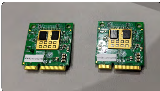
Slika 8: Ploščici VF sprejemnika in oddajnika preko katerih poteka Ethernet signal
