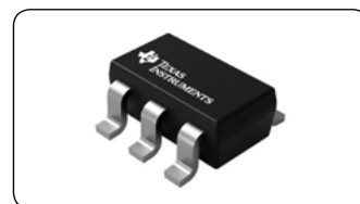
Slika 4: REF35 v 6-pin ohišju SOT-23
