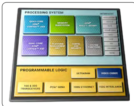
Blok diagram notranjosti čipa
