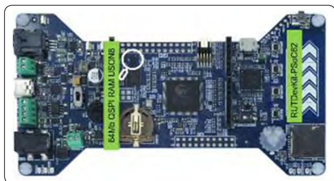
Slika 7: Z zunanjim pomnilnikom IoT RAM je RDK2 sodobna in preprosto uporabna strojna platforma zlasti za razvoj nosljivih naprav in tipal (slika: Rutronik)
