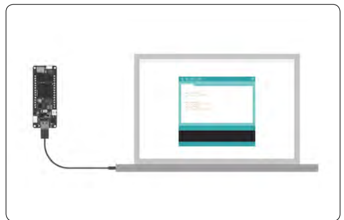
Slika 3: Povežite ploščo preko USB-C kabla s svojim osebnim računalnikom
