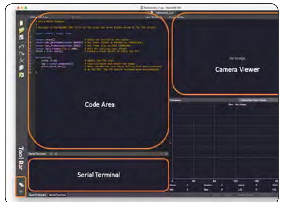
Slika 12: Okno OPENMV IDE in zajem iz kamere
