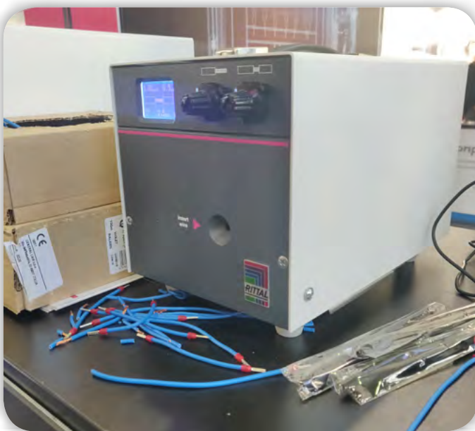
Slika 4: Naprava za snemanje izolacije in natikanje votlice
