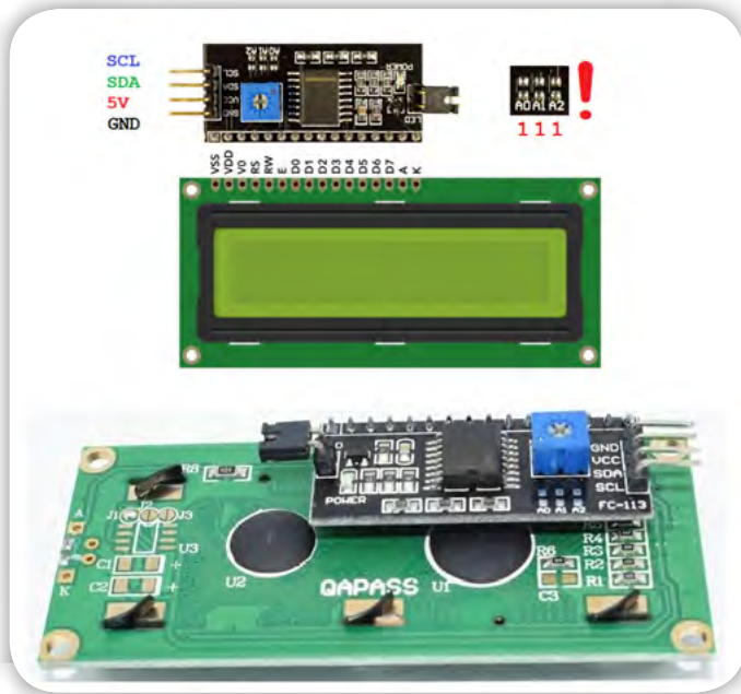
Slika 13: I2C modul s PCF8574 čipom se postavi na ozadje LCD-ja
