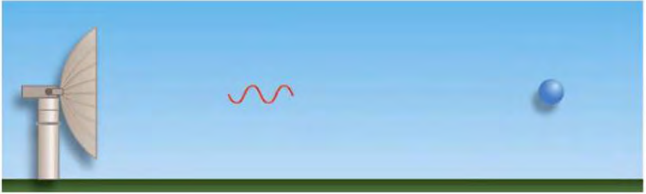
Slika 2: Princip delovanja radarja
