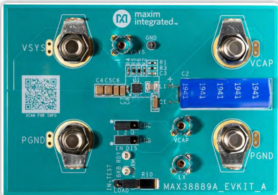
Slika 7: komplet MAX38889AEVKIT zagotavlja fleksibilno vezje za ocenjevanje rezervnega regulatorja superkondenzatorja MAX38889 buck/boost. (Vir slike: Analog Devices)
