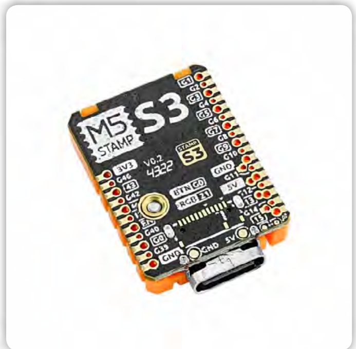
Slika 3: MCU ESP32S3 M5Dial je v tem modulu - M5StampS3. Ta se priključi v vtičnico na zadnji plošči M5Dial modula.
