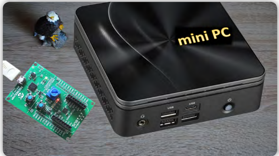
Slika 4: Mini PC in Microchip-ova razvojna ploščica MPLAB Xpress z mikrokontrolerjem PIC16F18855 ter programatorjem in mostom USB
