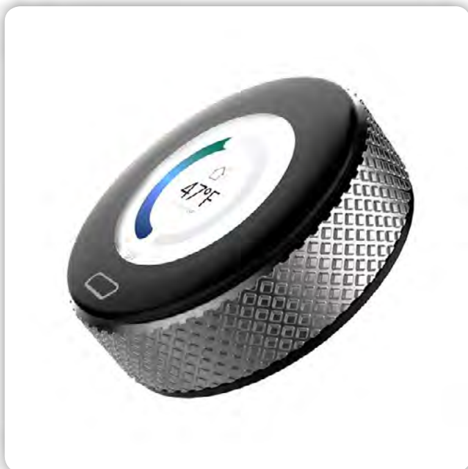
Slika 1: To je vrtljivi enkoder Grayhill z vgrajenim TFT zaslonom. To robustno enoto sem najprej odkril, vendar je bila za moje namene veliko predraga.
