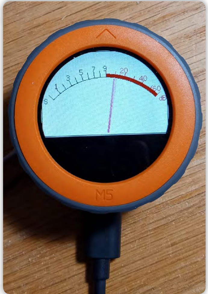
Slika 8: Z nekaj spremembami skice VU metra sem jo spremenil tako, da prikazuje standardni „analogni“ S-meter, ki se uporablja v radioamaterskih napravah itd.
