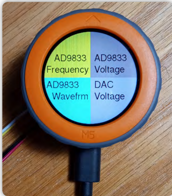
Slika 6: To je preprost zaslon menija, ki sem ga zasnoval za M5Dial. Z zaslonom na dotik lahko izberete eno od štirih možnosti. Vendar zaradi majhnosti zaslona ne morete pričakovati, da bo zaslon na dotik lahko razločil predmete, ki so veliko manjši od štirih prikazanih območij.
