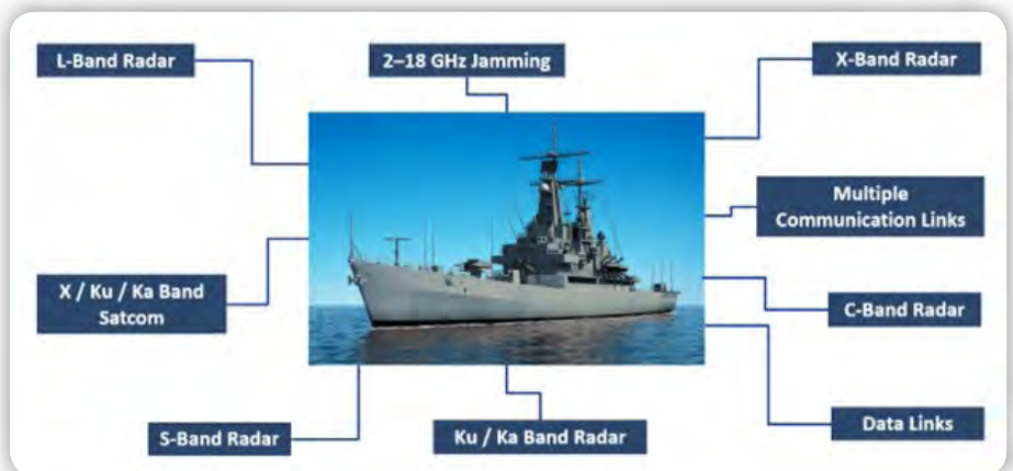
Slika 4: Pomorska radarska komunikacija uporablja frekvence v pasovih S, L, C, X vse do pasu Ku/Ka.
