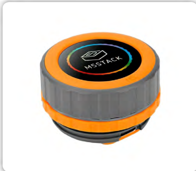
Slika 2: Vrtljivi enkoder M5Dial. Ima TFT zaslon podobno kot Grayhill, vendar je občutljiv tudi na dotik. Uporablja ESP32S3, tako da ima možnost WiFi in Bluetooth komunikacije.
