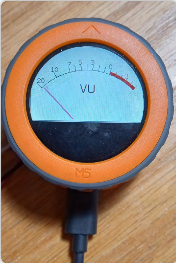
Slika 7: Ta fotografija prikazuje prikaz VU metra na M5Dial. Skico sem priložil programskemu paketu, ki je priložen k članku.
