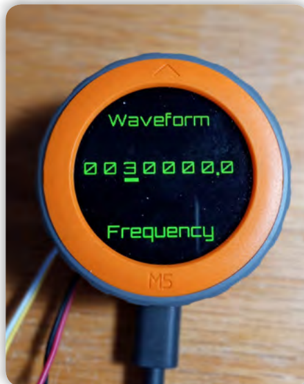
Slika 7: Meni za izbiro frekvence AD9833. Z enkoderjem izberete številko in se dotaknete zgornjega ali spodnjega dela zaslona, da povečate/zmanjšate vrednost.
