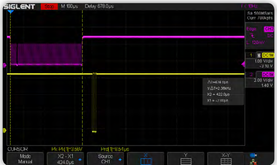
Slika 3: Tipičen paket I2C ukazov, kot ga pošlje M5Dial v RP2040 Xiao.
