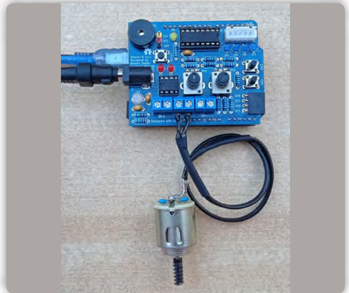
Slika 12: Shield-B z elektromotorjem vezanim v H-most
