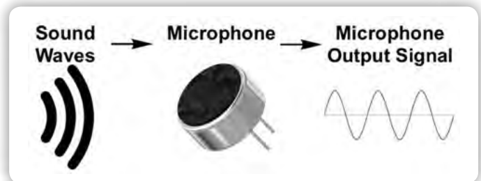
Slika 1: Mikrofoni pretvorijo zvok, ki se po zraku prenaša v obliki izmeničnih nihanj zvočnega tlaka, v ustrezne spremembe električne napetosti kot signal mikrofona. (Slika: PUI Audio)
