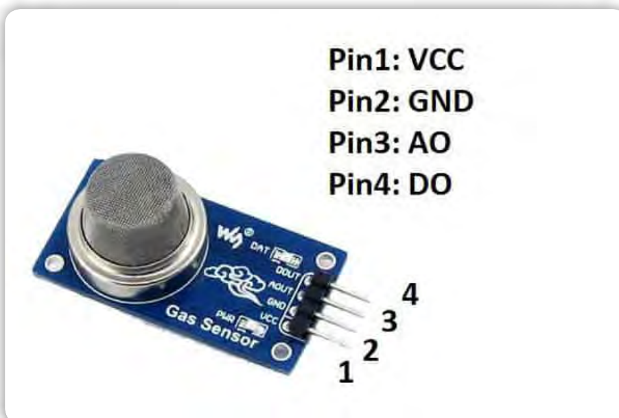
Diagram priključkov senzorja plina MQ2
