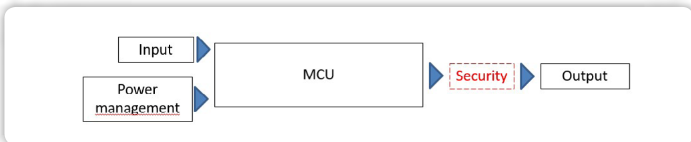
Slika 2: Močno poenostavljena zgradba IoT naprave z dodatno varnostno strojno opremo (slika Rutronik)
