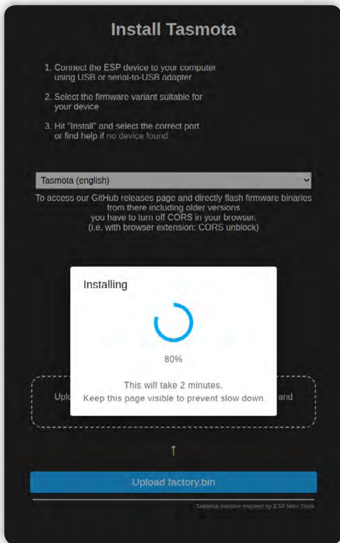
Slika 2: Programiranje LilyGo TTGO T-Internet POE razvojne ploščice z ESP32 modulom z Web Installerjem.
