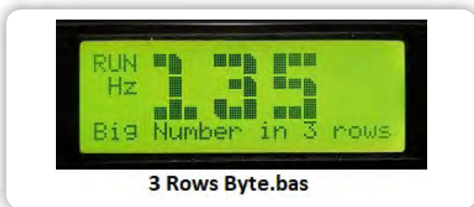
Slika 1. Primer trivrstičnega prikaza Byte spremenljivke
