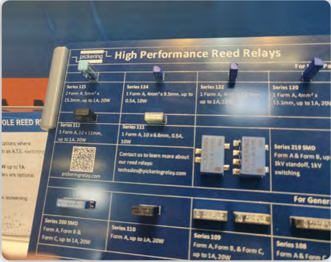
Slika 14: Slika novega reed releja #125 podjetja Pickering
