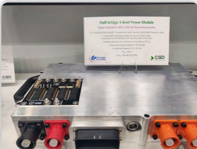
Slika 9: Inverter za krmiljenje avtomobilskih motorjev
