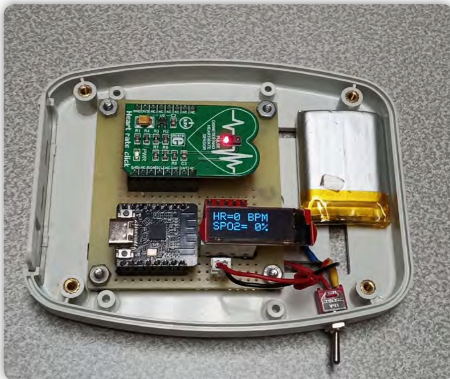
Slika 12: Končni projekt z odstranjenim zgornjim pokrovom
