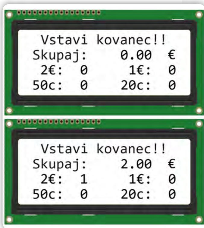
Slika 3: Tehtnica je v delovnem stanju in je pripravljena sprejeti prvi kovanec (zgoraj); prikaz na LCD zaslonu ko je v sortirko spuščena kovanec od 2 EUR (spodaj)
