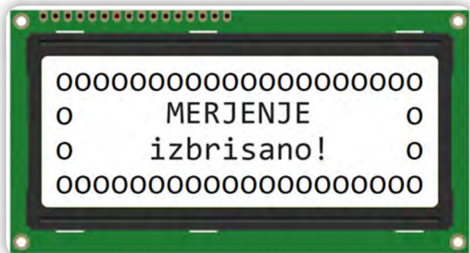
Slika 4: Sporočilo na LCD zaslonu potrjuje da je zadnja meritev preklicana
