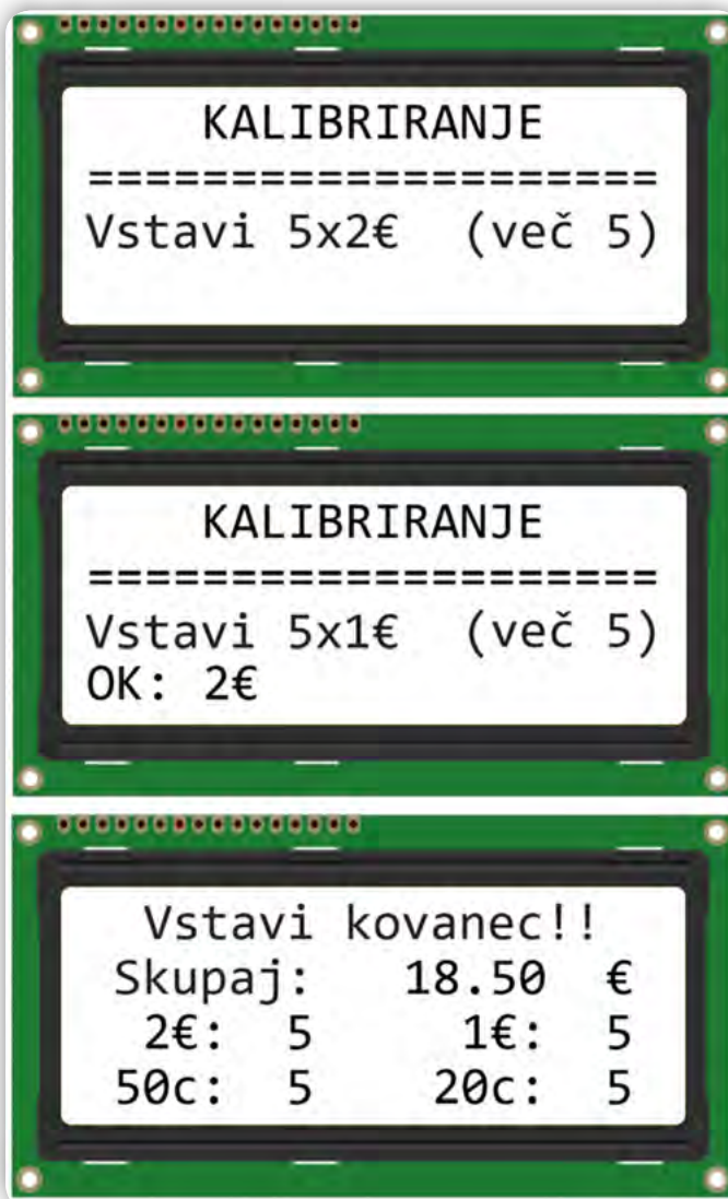
Slika 5: Sporočila na LCD zaslonu med kalibriranjem tehtnice
