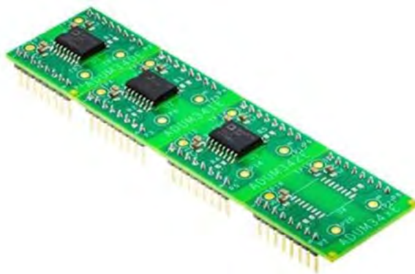
Slika 6: Razvojna plošča EVAL-ADuM34XEEBZ podpira vse tri naprave ADuM34xE in ima odprto lokacijo za uporabnikovo izbiro naprave, združljive s pinoutom. (Vir slike: Analog Devices)
