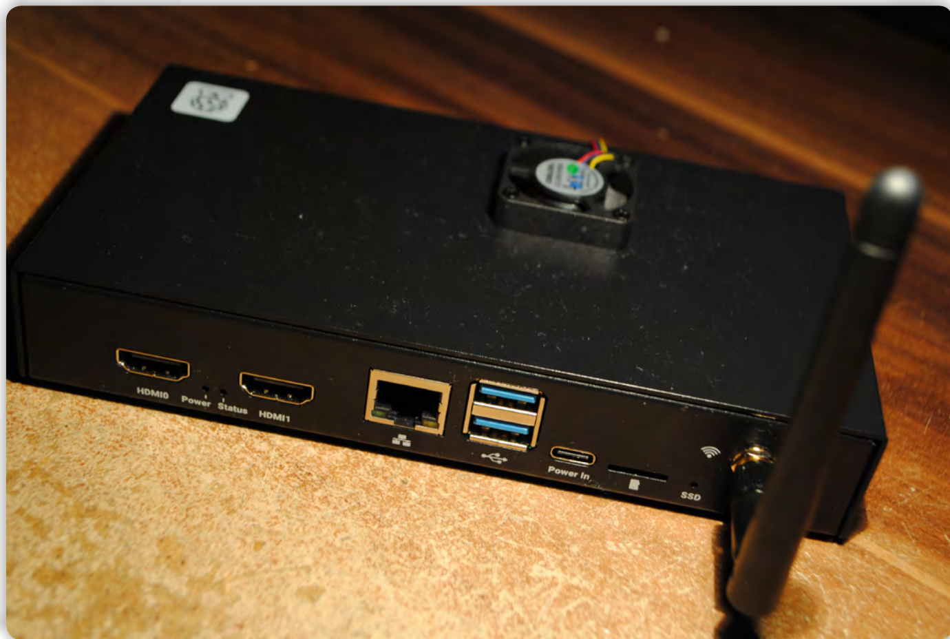
Slika 3: Na vrh ohišja nameščen ventilator, ki izsesava vroč zrak iz hladilnega rebra in s tem bistveno izboljša zmogljivost hlajenja, s čemer je mogoče stabilno navijanje na 3 GHz
