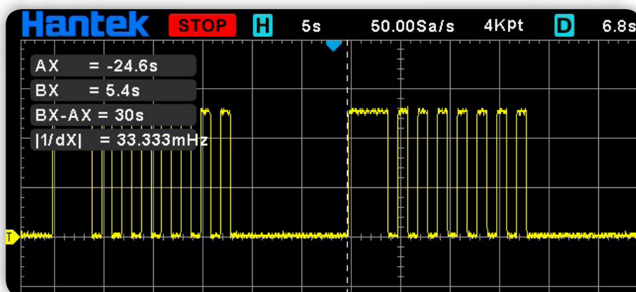
Slika 8: Izmerjen potek PWM za primer, ko se spreminja izhod PID-a znotraj periode 30s. Output = 10, 30 in 60. Rele izmenično preklaplja. Čas preklapljanja releja določa najvišja vrednost Output = 60. Ko je ta prekoračena (18s), je rele izklopljen do konca periode. PWM je enaka 33%.
