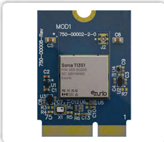
Slika 5: Modul Sona TI351 453-00209 uporablja priključek M.2 2230 Key E za sistemske konfiguracije, ki jih je mogoče priključiti. (Vir slike: Ezurio)
