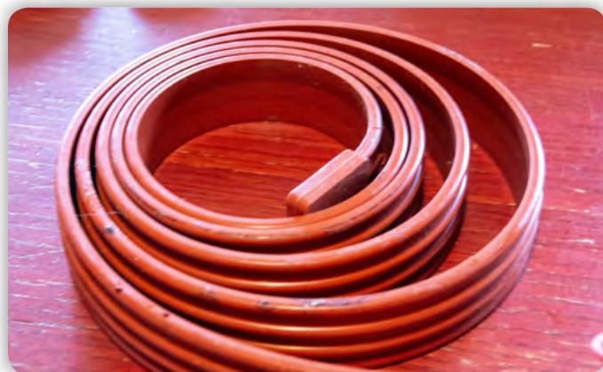
Slika 2: Grelni trak, ki ga ovijemo okoli fermentorja in priključimo na 230V preko SSR
