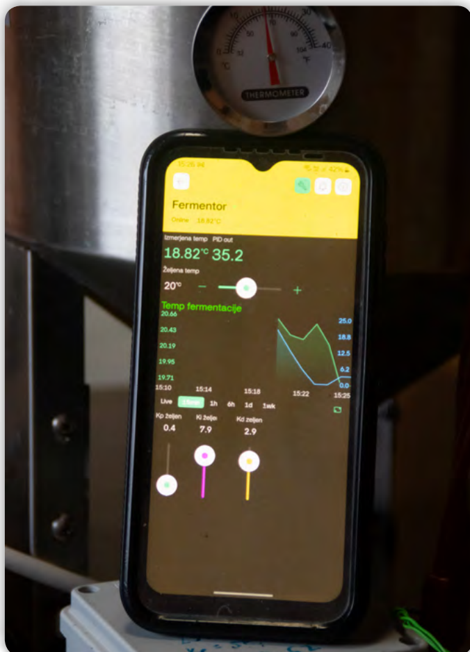
Slika 15: PID z ESP8266 v akciji na fermentorju pивine. Z drsniki lahko nastavljamo PID parametre in želeno temperaturo.
