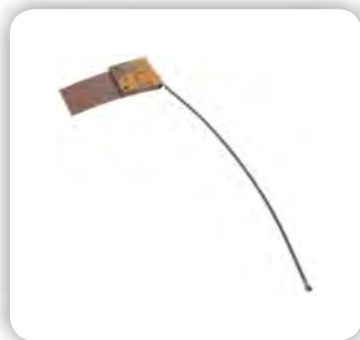
Slika 6: EFB2471A3S-10MH4L je tripasovna 2,4/5/6 GHz, 5-vatna antena.
