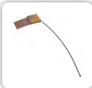
Slika 7: 001-0021 je dvopasovna antena 2,4/5 GHz. (Vir slike: Ezurio)
