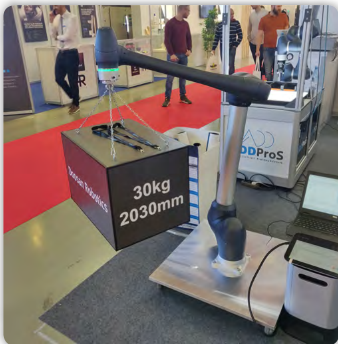
Slika 8: Robotska roka zmore prenesti 30 kg.
