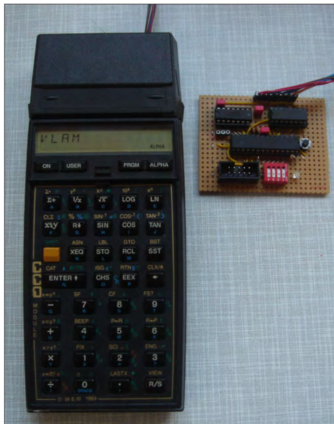
Slika 11: Dokaz da vse deluje tako, kot bi moralo: kalkulator prepozna ROM modul vpisan v razvojni komplet.
