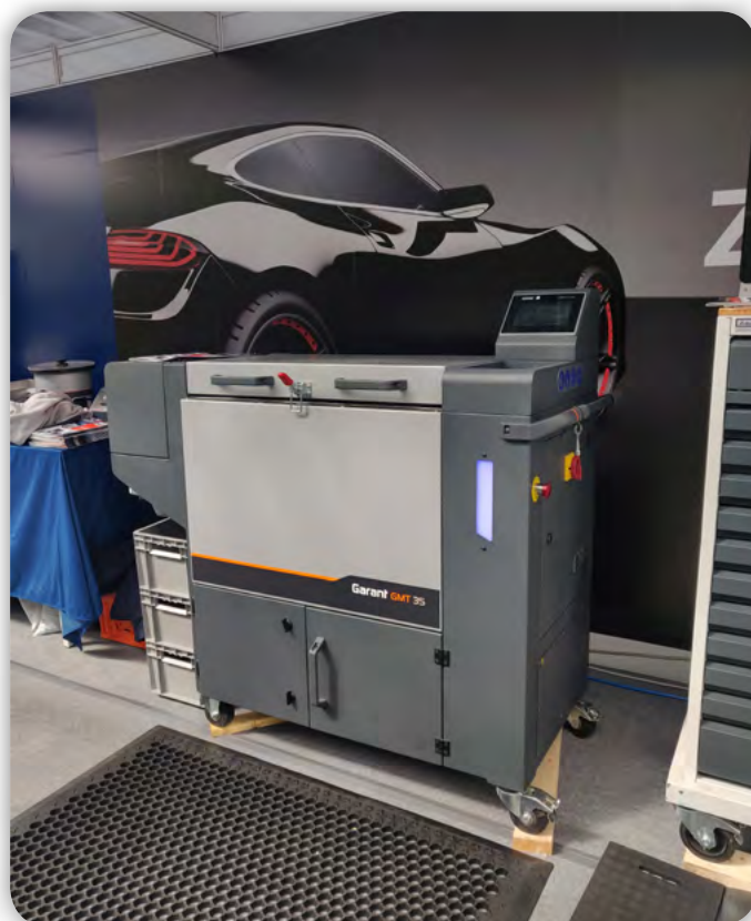
Slika 14: Naprava GMT za obdelavo majhnih delov
