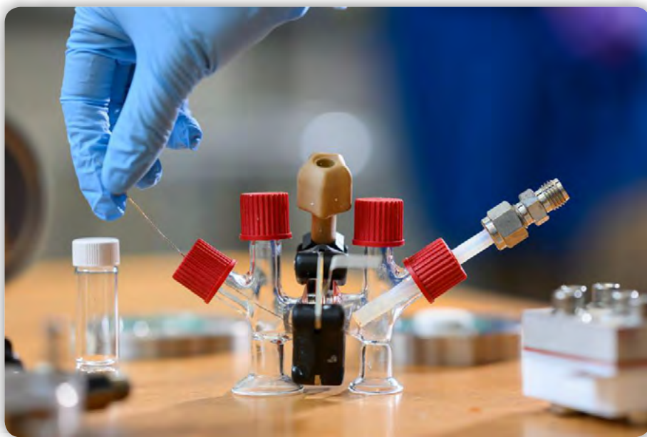
H-celica, ki je bila spremenjena z elektrodami in ionsko prevodno keramično membrano za izvajanje poskusov z gorivnimi celicami natrij-zrak. Vir: Gretchen Ertl
