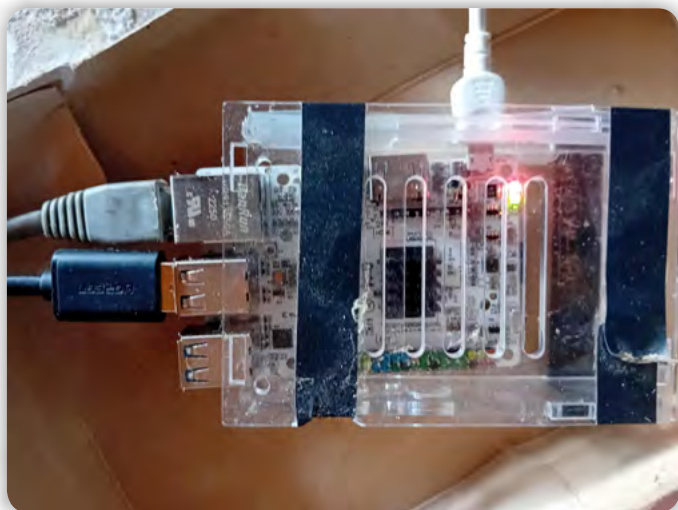
Slika 8: Klon Raspberry Pi povezan na LAN in SDR sprejemnik
