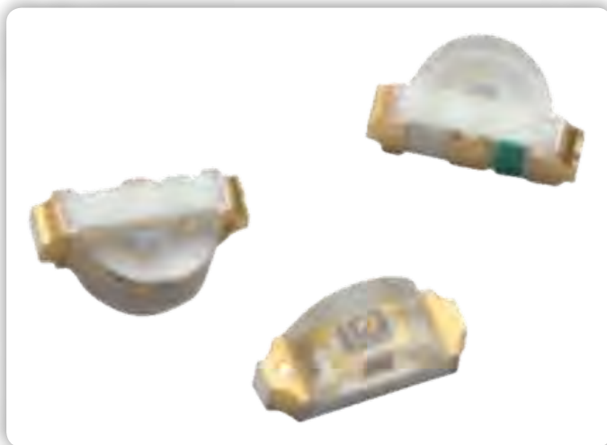
Slika 2: HSM8-C120 ChipLED IR LED oddajnik podjetja Broadcom ponuja vršno valovno dolžino 850 nm in ima kompaktno velikost, zaradi česar je primeren za tiskano vezja, ki imajo gosto postavljene komponente. (Vir slike: DigiKey)
