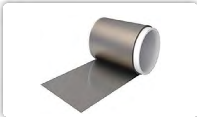
Slika 4: FLEX SUPPRESSOR® za Wi-Fi pas in 5G je fleksibilni polimer, ki vsebuje magnetni prah v mikronskem obsegu. Uporabniki lahko liste razrežejo na želeno velikost, da zmanjšajo elektromagnetno resonanco ali spodbudijo konvergenco magnetnega pretoka. (Vir slike: KEMET Corporation)
