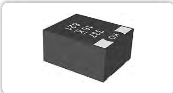
Slika 5: Polimerni elektrolitski kondenzatorji T523 imajo tantalovo anodo in tantalovo-polimerni elektrolit, ki tvori del katode. Oblikovano epoksi ohišje se pritrdi na tiskano vezje s tehnologijo površinske montaže (SMT). (Vir slike: KEMET Corporation)
