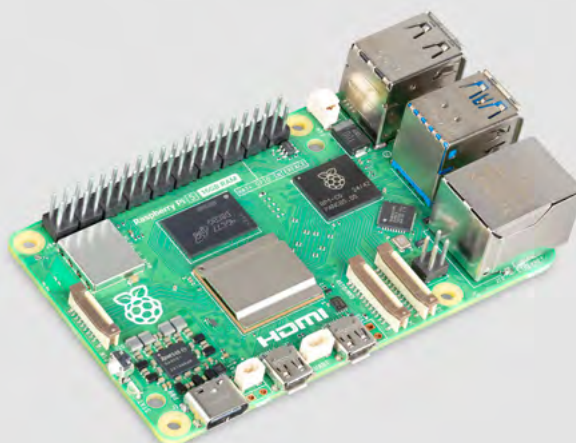
Slika 2: Raspberry Pi 5 ima zelo podobno razporeditev konektorjev.
