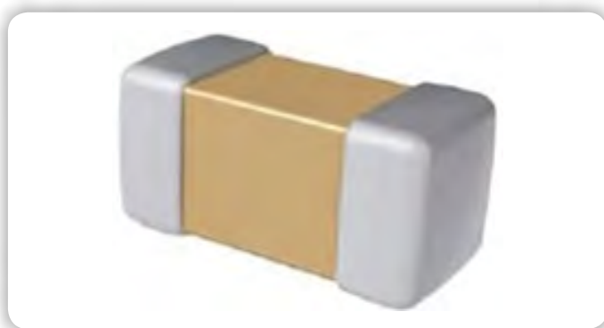
Slika 2: Kondenzatorji HiQ-CBR so MLCC-ji, zasnovani za delovanje pri višjih frekvencah, ki jih uporablja infrastruktura 5G. Keramični dielektrik razreda I je kombiniran z vodniki iz navadne kovine in končnimi pokrovi iz matiranega kositra v komponentah za površinsko montažo (SMD). (Vir slike: KEMET Corporation)
