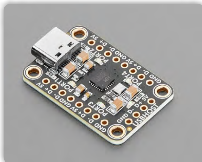
Slika 3: CH334F USB spojnik iz 1 na 4, ki ga lahko uporabimo tudi v lastnih projektih, je pa tudi del ESP32-P4 Modula
