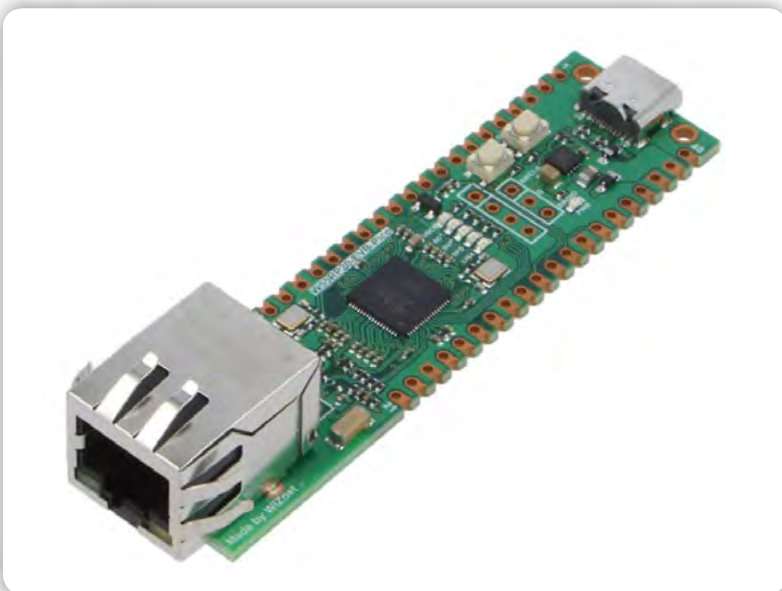
Slika 2: Plošča ima USB C konektor za napajanje in programiranje čipa.
