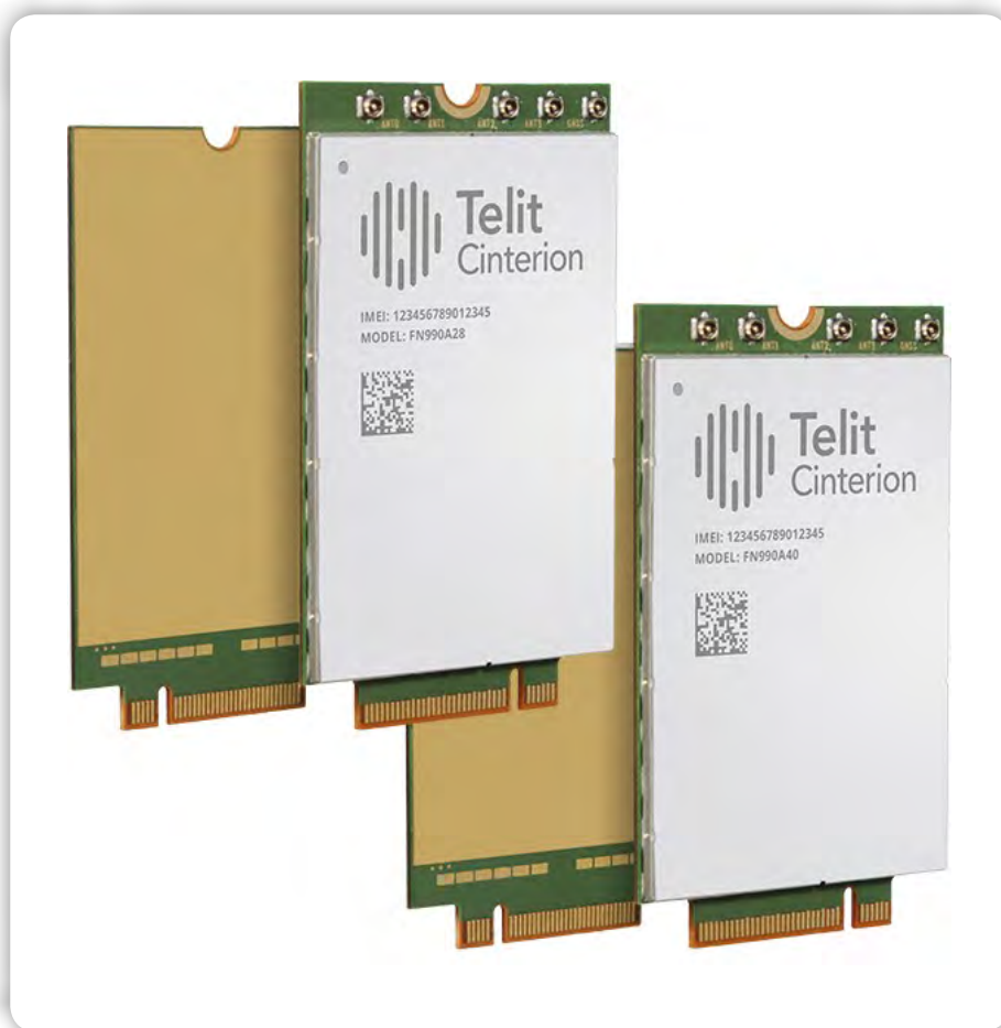
Te podatkovne kartice (FN990A40/A28, FN990A40-HP/A28-HP, LTE/5G podatkovna kartica) tvorijo osnovo za IoT, podjetniške aplikacije in video. Omogočajo takojšen dostop do prednosti 5G in gigabitnega LTE (vir: Telit Cinterion)
