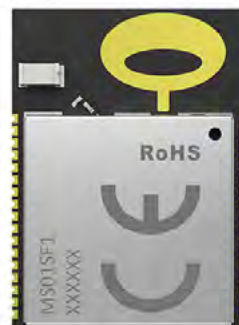
Slika 4: MinewSemi MS01SF1 – modul za skladiščenje, logistiko in nadzor dostopa, s TWR in TDoA
