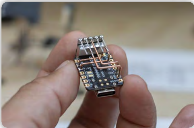
Slika 10: Spajkanje krmilnega modula
