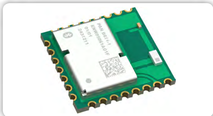
Slika 3: Modul PAN-B611 z vgrajeno anteno (vir: Panasonic:)
