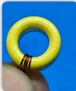
Slika 12: VFO toroid z začetnimi 4 ovoji. Upoštevajte, da so ovoji blizu drug drugega, se ne prekrivajo in so tesno naviti.
