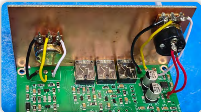
Slika 11: Namestitev in vezava potenciometrov
