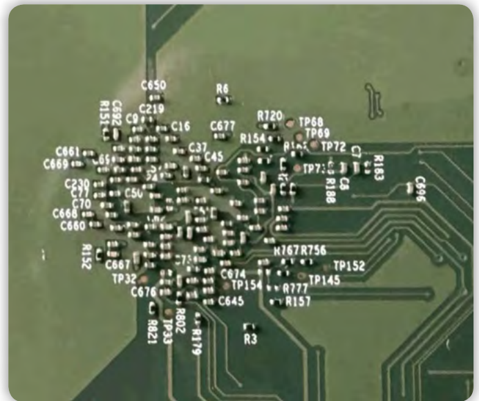
Slika 5 Blokirni kondenzatorji pod mikroprocesorjem [4]
