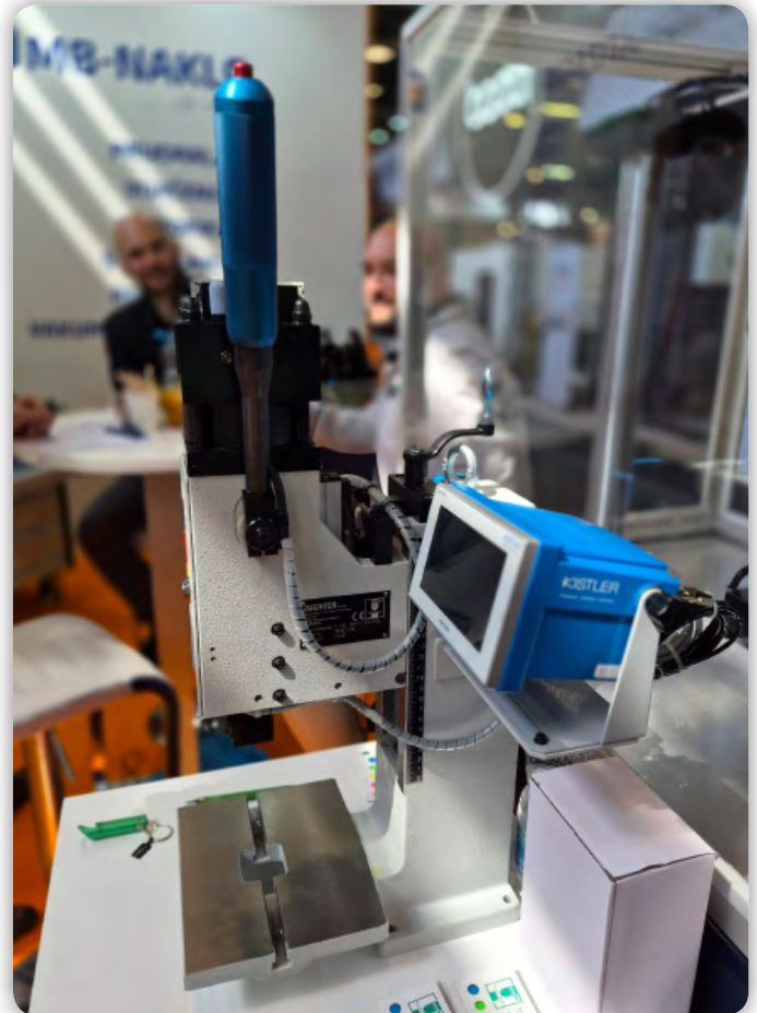
Slika 8: Ročna stiskalnica s pnevmatskim 5 mm hodom
