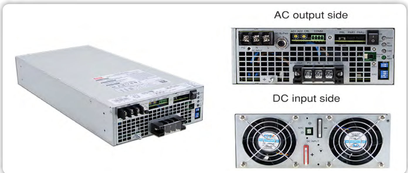
Slika 4: NTN-5K-2380 je avtonomni enosmerno-izmenični pretvornik z resnično sinusno valovno obliko, vgrajenim izmeničnim polnilnikom in funkcijo UPS (obvod za izmenično napetost). Pri vhodni napetosti 380 VDC zagotavlja neprekinjeno izhodno moč 5000 vatov in izhodno napetost 230 VAC. (Vir slike: MEAN WELL)
