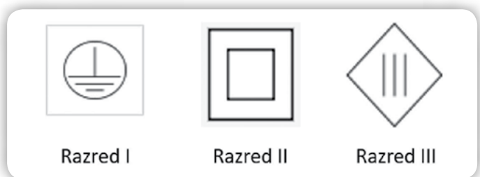
Slika 2: Simboli zaščitnih razredov električne opreme.
